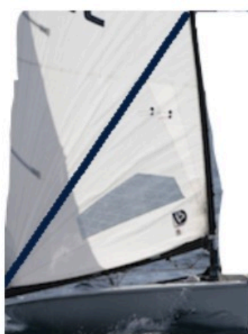
pli marqué: manque d'adaptation mât/voile (ici le pli est assez peu marqué, donc pas ou peu de pénalisation)
